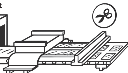
5 - Assemblage du vitrage par le menuisier dans un cadre pour obtenir la fenêtre
